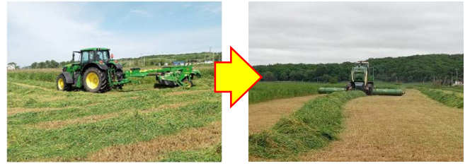
写真-7 不陸（凹凸）の解消により機械が大型化
