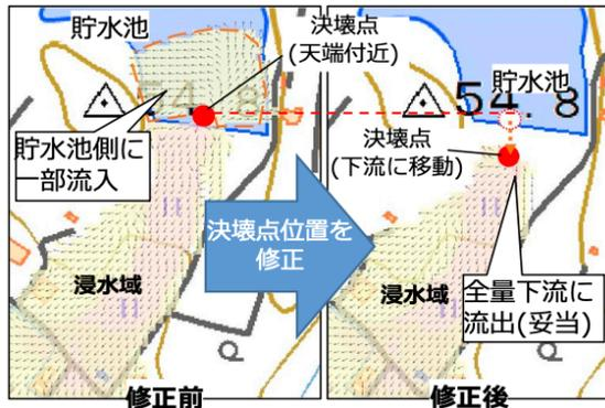
図-6 決壊点位置の典型的な設定ミス例（「ため池ハザードマップ作成のための浸水想定区域算定マニュアル（案）」より転載）
