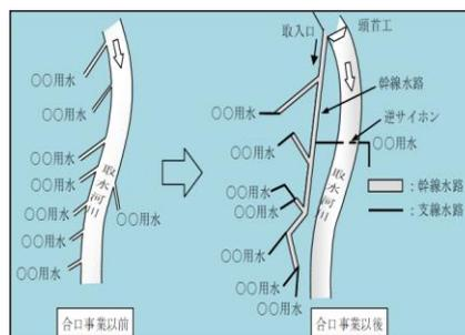
Fig.1 合口によるシステムの再編
