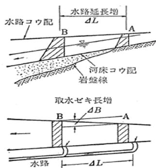
Fig. 2 頭首工の位置選定の模式図 (農業土木ハンドブックより転載)
