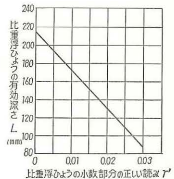
図-5 比重浮ひょうの正しい読みと有効深さの例 (JIS)
