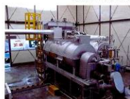
低コストでの炭化技術のための炭化装置試験機
