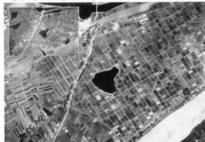
同じく豊後と区画整理されたホ場。この地区は地下水が高いので、地下水を低下させ、乾田化するに重点がおかれた。ホ場一画は 2,000 x 125 m (2.5 ha) である（左上は区画整理前の空中写真）（高知県中地区）
