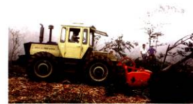
2. 機械生による不耕起造成法（フッシュ カッター）
