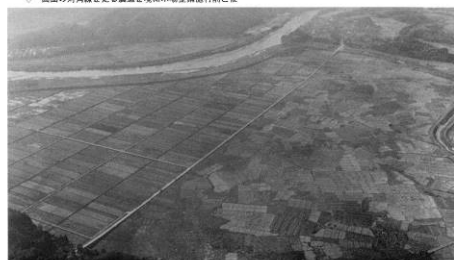
③ 画面の対角線を走る農道を境に水場整備施工前と後
