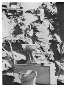
砂置検法による締固め度試験
