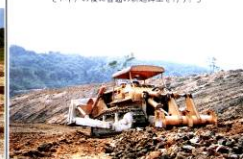
Ⅲ. リッパ工法（秋田県山田郡） 「表土がうすく、足跡露出地ではリッパ 機前後、草根腐爛などの退化期間（約 1年）の後に普通の牧草種子を播く。」
