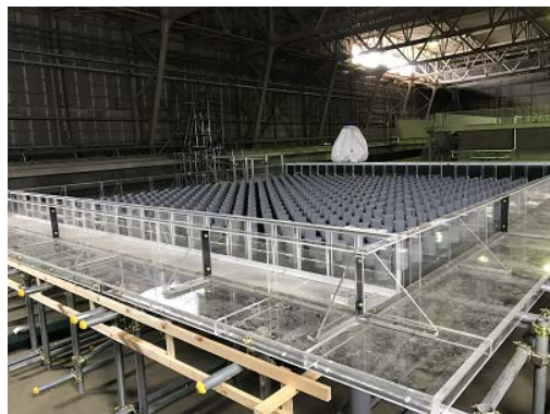
Pic. 1 水田模型実験装置 Experimental paddy model
