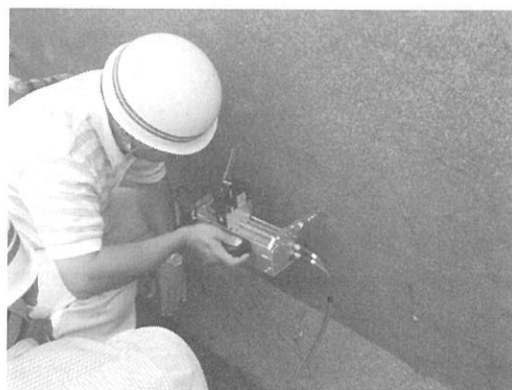
図-6 凹凸形状測定装置
