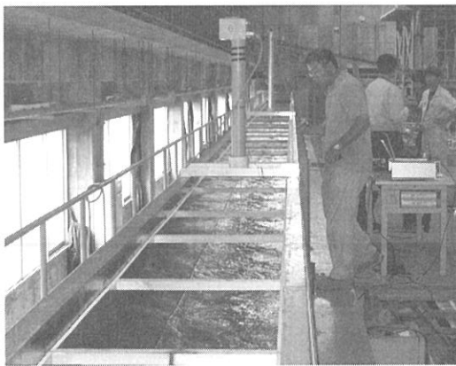
図-7 摩耗を模擬したコンクリート板の高精度水理模型実験
