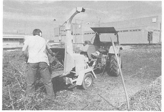
写真-4 個人の庭や公園などで発生する剪定木や落枝を刻みチップにして、堆肥やチップ歩道の材料にする
