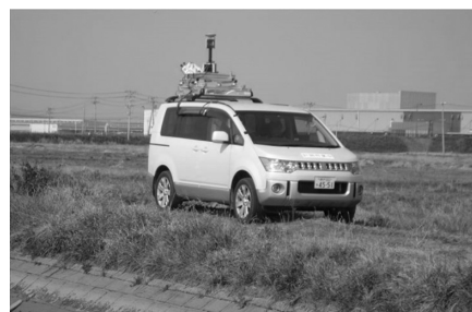
写真-3 走行中のMMS車両
