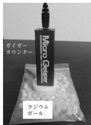
写真-2 線量計を用いた距離と遮蔽の演示実験
