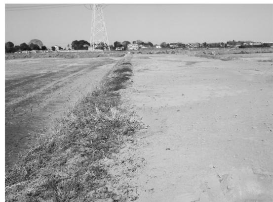
写真-2 噴砂が堆積した水田（畦畔右）と噴砂のない田面（畦畔左）
