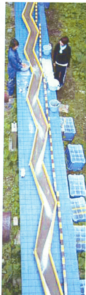
図—1 使用した屈折蛇行水路 水路幅：20 cm, 蛇行半波長：86 cm, 蛇行屈折角：24°，水路長：16m(07) & 8m(08)
