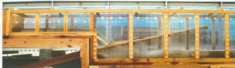
Fig.7 実験の様子(Q=12ℓ/s、勾配 1/5、段差 15cm)
