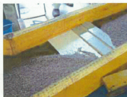
(c) 直角堰+斜路式護床工
