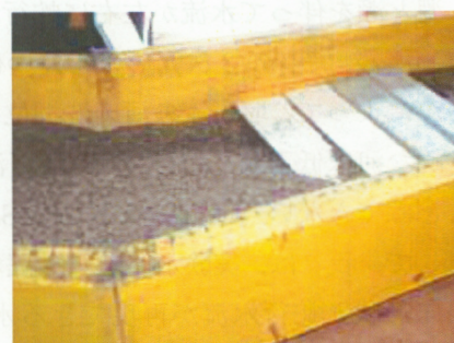
(b) 直角堰+2段式護床工
