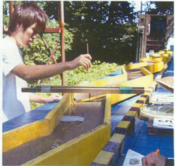
図-7 堰周辺の堆砂・洗掘形状 蛇行水路 0.6L/s, 初期砂床：上流+3mm, 下流+3mm (2007 年実験における横断測量の様子)
