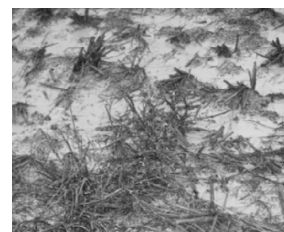
散布後の固化剤
