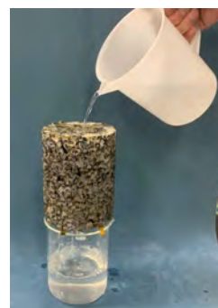
透水性改良体 (透水係数 k=1.0 \times 10^{-3} \text{m/sec} )
