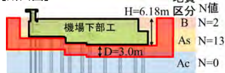
地盤改良土留め概要図
