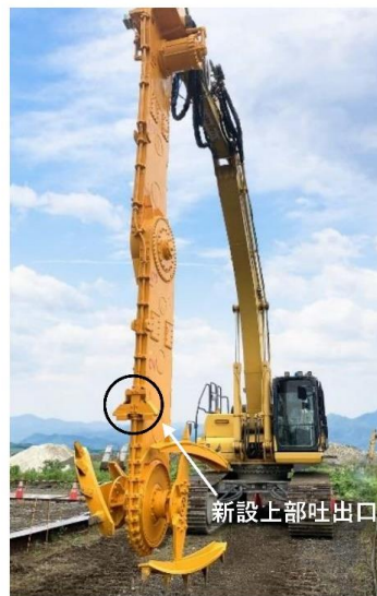
WILL-m工法施工機械全景
