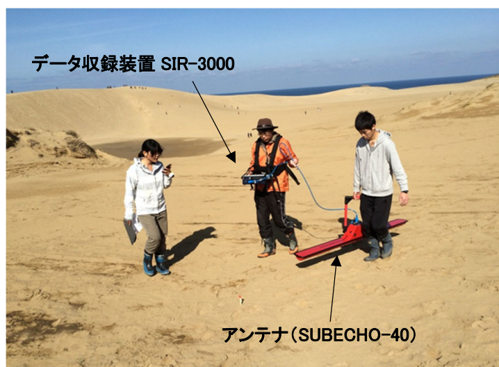
Fig.2 GPR 装置と探査の様子
