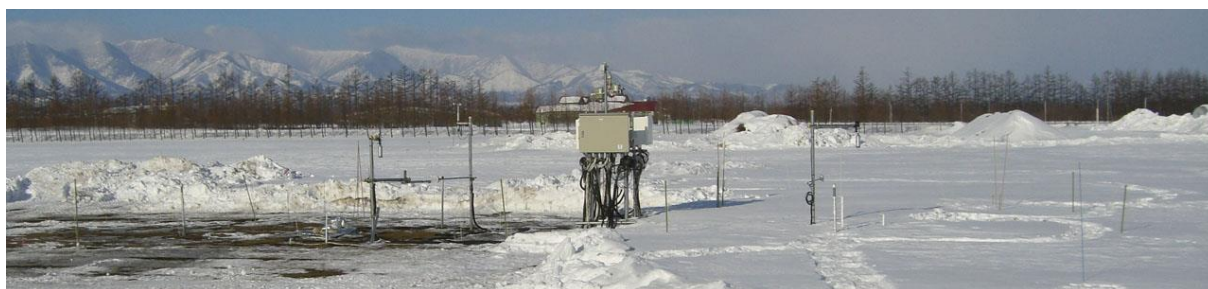
Fig. 3 北海道農業研究センター畑作研究部（北海道芽室町）の試験圃場に設置した除雪により土壌凍結深を発達させることで過去の圃場の条件を再現した試験区（左）と現在の積雪・土壌凍結条件の対照区（右）
