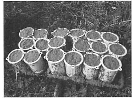
図 2 基盤材吹付けによる供試体の作成
