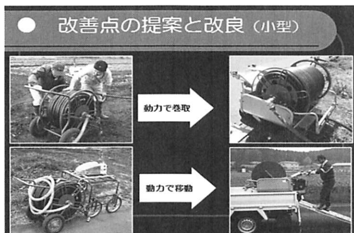
写真3 動力源設置などの改善と改良
