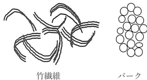
図6 吹付け基盤材の形態模式図
