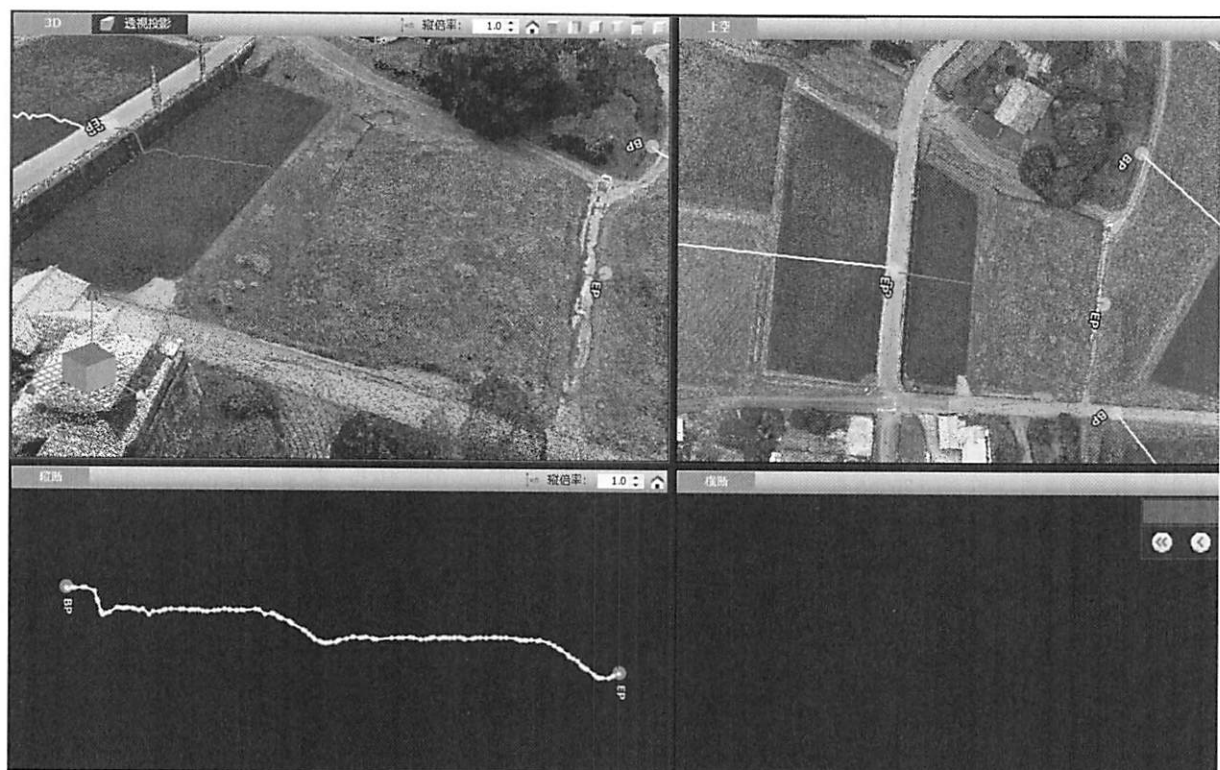
図5 点群3D データから縦断図作成
