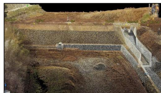
図7. 完成断面の点群データ
