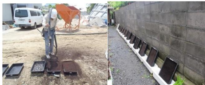
図2 基盤材の吹付けと侵食試験の要領
