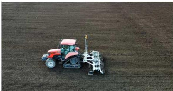
写真-1 レーザーレベラー均平整地状況
