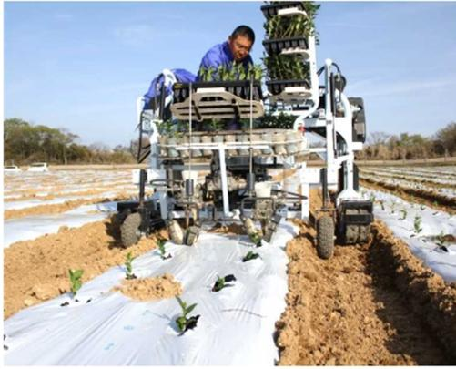
写真8 機械による定植作業
