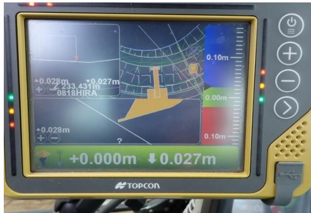
写真-2 オペレーターが確認する画面
