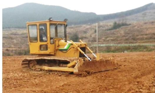
写真5 整地状況(超々湿地ブルドーザー4t級)
