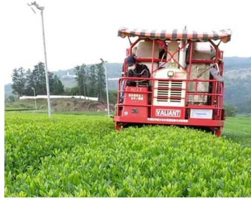
写真9 機械による収穫作業
