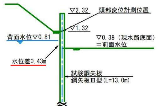
図-3 試験鋼矢板概念断面図
