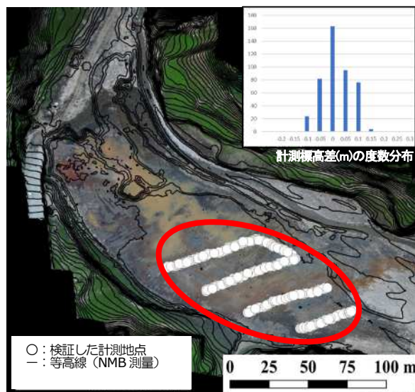
図-3 魚群探知機による計測の精度検証例(Aダム)
