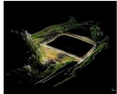
図2 点群データ(地上型レーザー)
