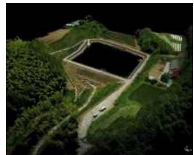
図4 点群データ(写真測量+SfM)
