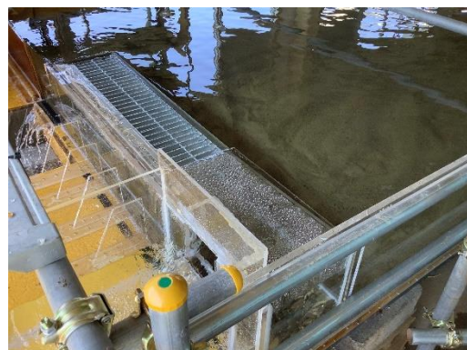
写真 2 模型頭首工（堰と取水工）
