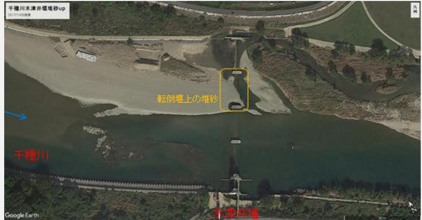
図-17 千種川木津井堰（兵庫県赤穂市）の転倒堰起立不能状況
