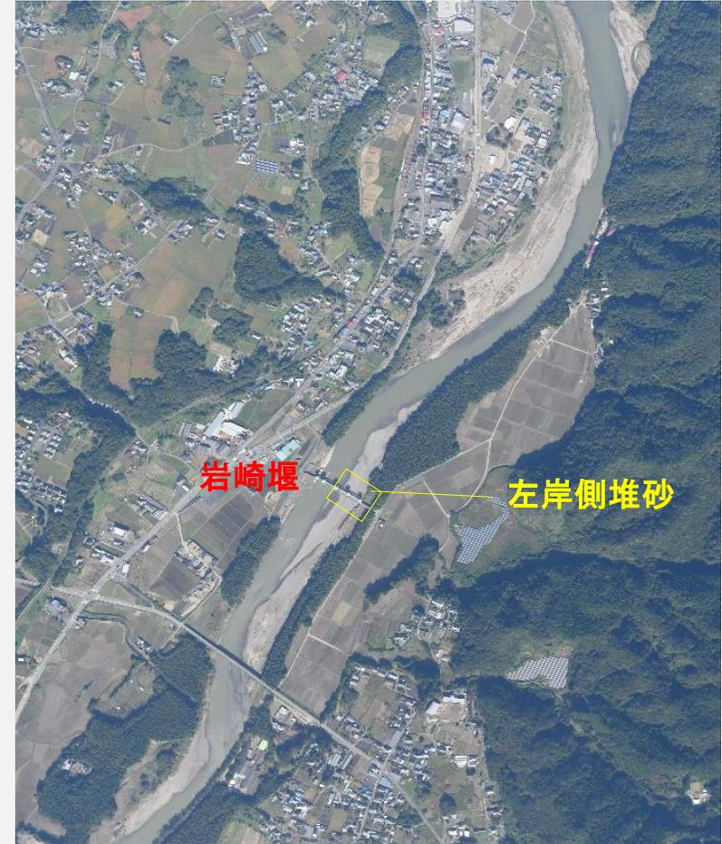
図-18 久慈川岩崎堰（茨城県常陸大宮市）土砂吐ゲート部の2019年洪水後堆砂
