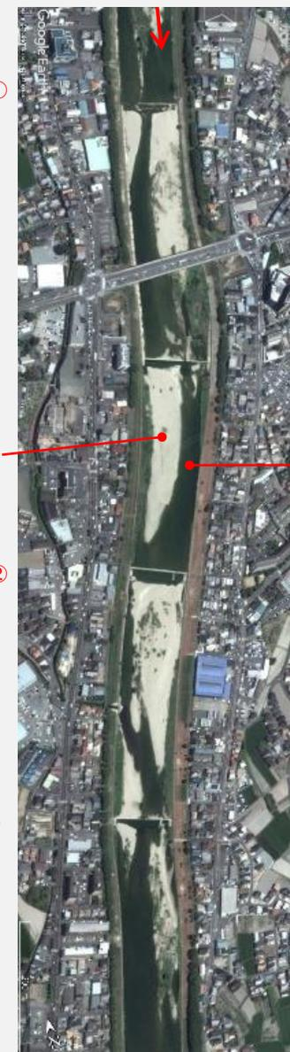
図-11 床止め工が設置された河川における砂礫堆の形成
