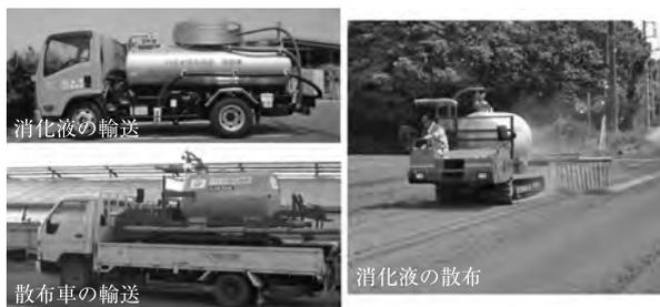
写真-1 消化液の輸送・散布作業に用いる車両
