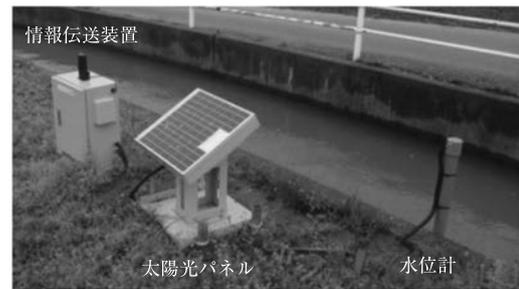
写真-2 ICTを活用した遠方監視システムの設置状況
