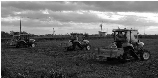
写真-1 遠隔監視による農業機械の無人走行の実証
