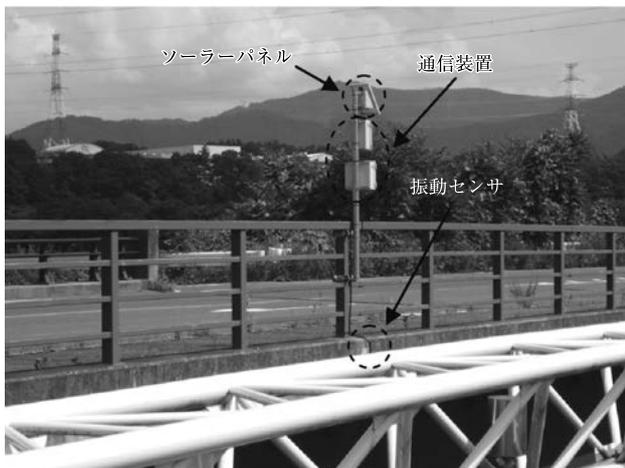
写真-2 振動センサを利用した橋梁の劣化状況把握
