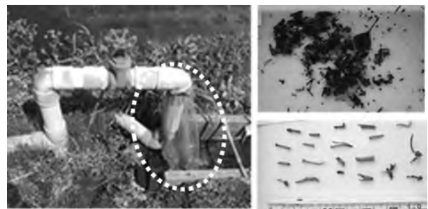
写真-4 給水栓に取り付けられた収穫ネット(左)、流入するゴミ(右上)とゴミに混じるナガエツルノゲイトウ断片(右下)
