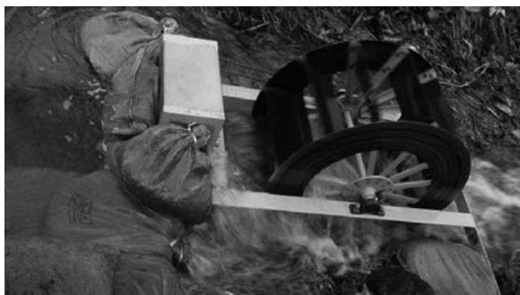
写真-1 開放周流形（下掛け式）ピコ水力発電装置の例
