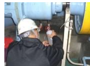
トライボロジー（潤滑油などの性状の変化の診断）によるポンプの劣化診断技術
