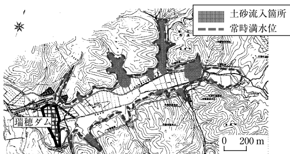
図-9 貯水池への土砂流入箇所
