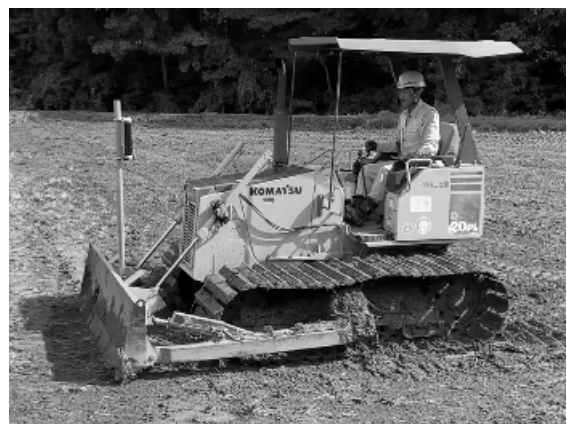
写真-5 ICTブルドーザ（商品名：コマツ D20PL）
