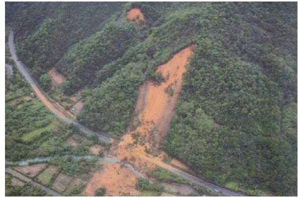
**Photo 4** 河川隣接斜面で発生した崩壊（秋名川）
