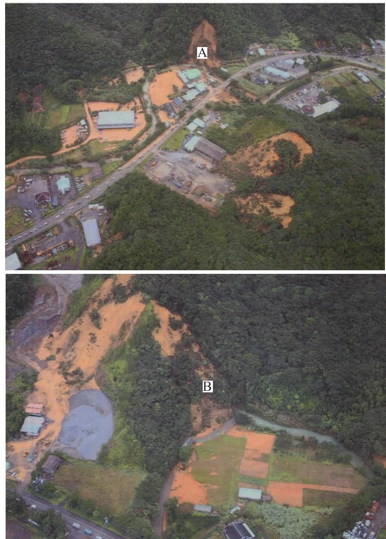
Photo 3 中勝川中流域河川隣接斜面で発生した崩壊性地すべり A(上, Fig.4 中 A) および B(下, Fig.4 中 B) (鹿児島県大島支庁建設部提供航空写真に加筆)
