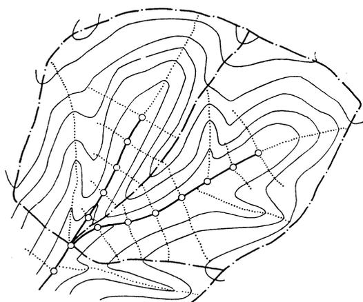
図-9 谷線法によるコウ配計測
