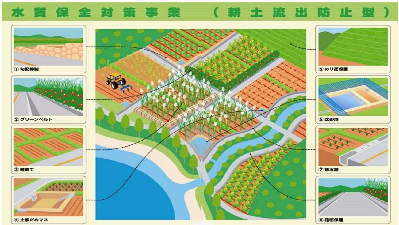
**Fig.4** 水質保全対策事業(耕土流出防止型)のイメージ(沖縄県の農業農村整備)
