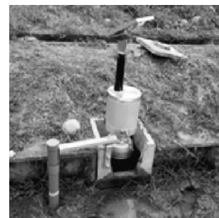
写真-1 遠隔・自動給水バルブ
