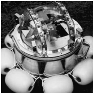
写真-2 水路トンネルの無人点検ロボット
