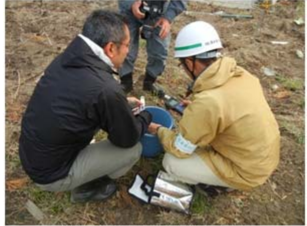
写真13 排水路の水質(EC)調査
