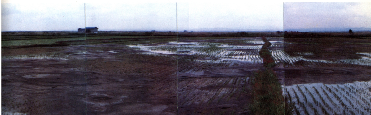
八郎湯干拓地 B16 圃場の噴砂（写真提供：土崎哲男）
