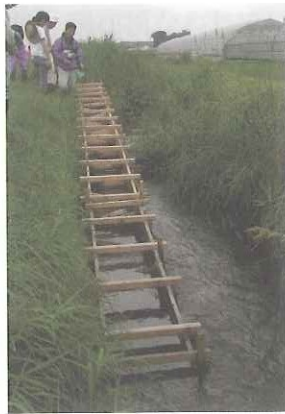
簡易な魚道での遡上試験のイメージ (写真：栃木県 小貝川西Ⅱ期地区)
