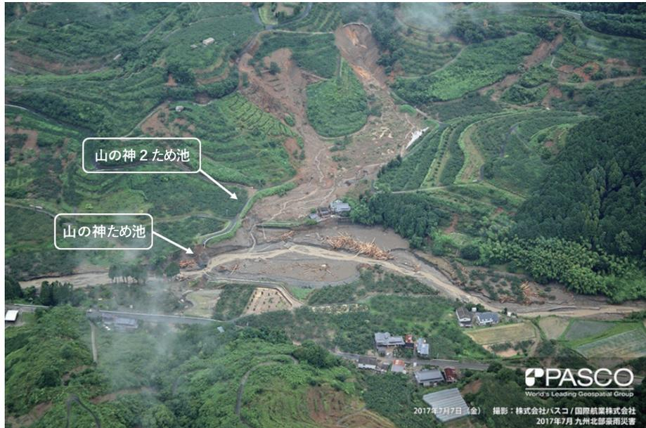
6. 山の神2ため池の背後地山の2カ所が大きく崩壊し、土砂がため池に流入
