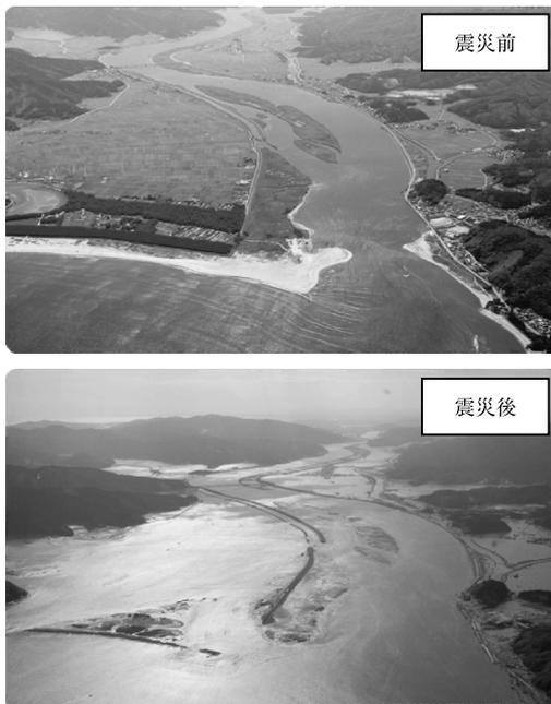
写真-1 長面工区河口部の被災状況
