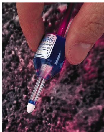
T5テンシオメータのセラミックチップの直径は5mm, 表面積は0.5cm<sup>2</sup>です。土壌の攪乱を最小限に抑えるため微小領域の測定に適しています。
