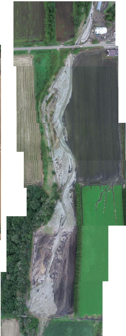
写真-1 小型 UAV を用いた排水路および農地の被災状況（平成 28 年 9 月 8 日撮影。右の写真の上下距離は約 670 m。左は同じ区域の被災前状況の Google earth の画像）
