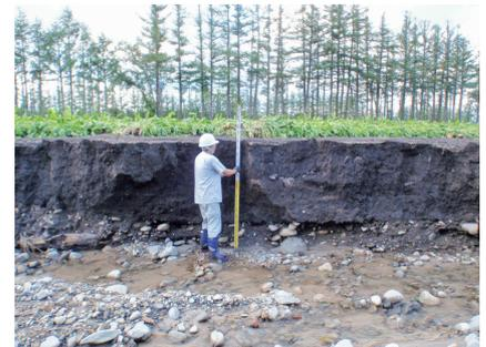
写真-4 氾濫した排水路の流水により侵食された農地の断面（作物はテンサイ）
