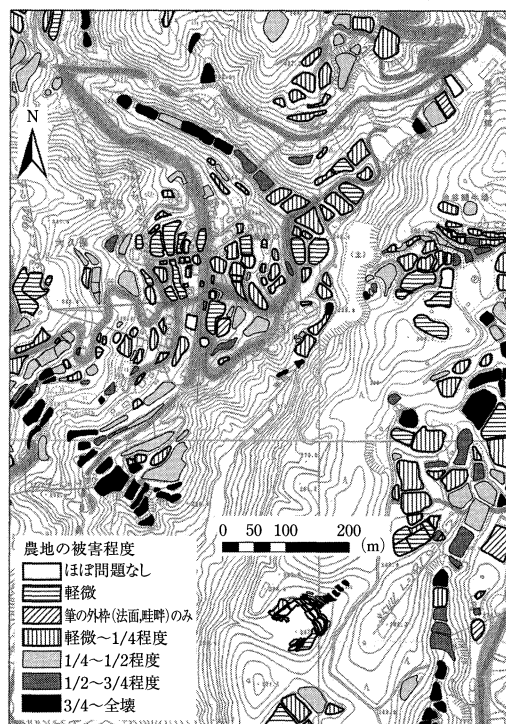
図-6 現地調査および高解像度画像から判読した震災直後の農地被災状況（大久保地区）
