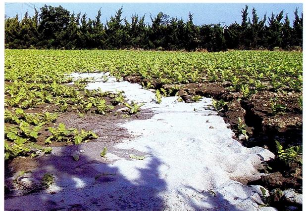
10. 亀裂型の噴砂跡 (弓浜)
