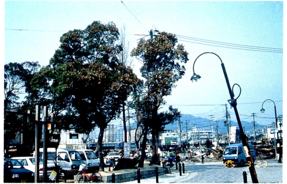
公園緑地の延焼防止機能（大国公園，1995年3月撮影） 焼失地区に隣接したクスノキの焼失程度が大きく，公園内部の樹冠部の焼失は少ない。
