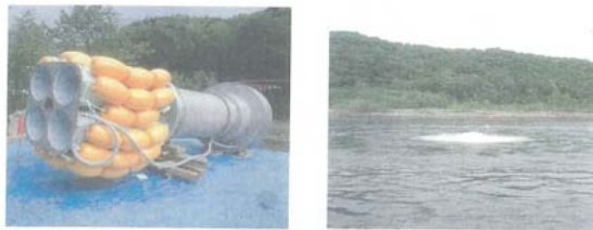
写真-41.1 ばっ気循環装置
