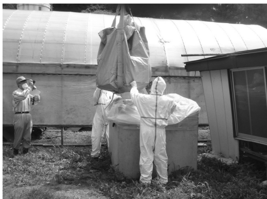
写真-2 稲わらを用いた遮蔽試験
