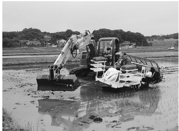
写真-1 近隣市町村における「盤抜け」状況
