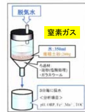
Fig.2.2 鉄とマンガン溶出実験装置概略図
