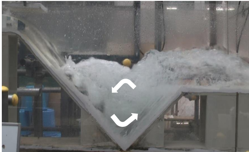
図-5 i=1/100 、 Q=22.8\text{L/s} 、 D=300\text{mm} における流況
