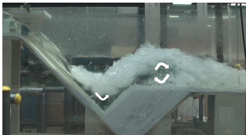
図-4 i=1/100 、 Q=22.8\text{L/s} 、 D=150\text{mm} における流況
