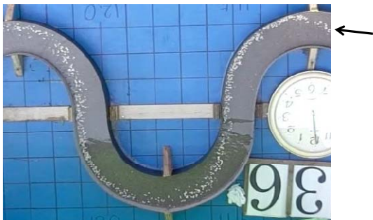
湾曲部外岸側の側壁に沿う流れ
