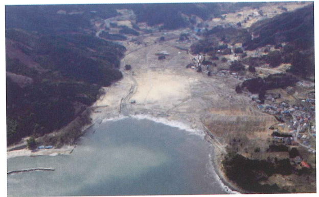
写真-1 吉浜海岸の被災状況 (左：白砂青松の吉浜海岸，右：砂浜が消失し農地や海岸堤防が被災，大船渡市)
