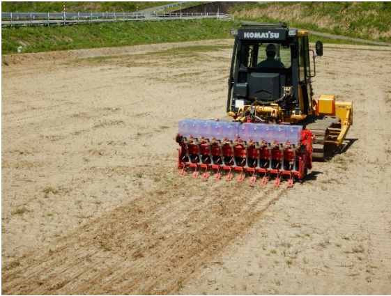
農業用ブルドーザ 直播作業
